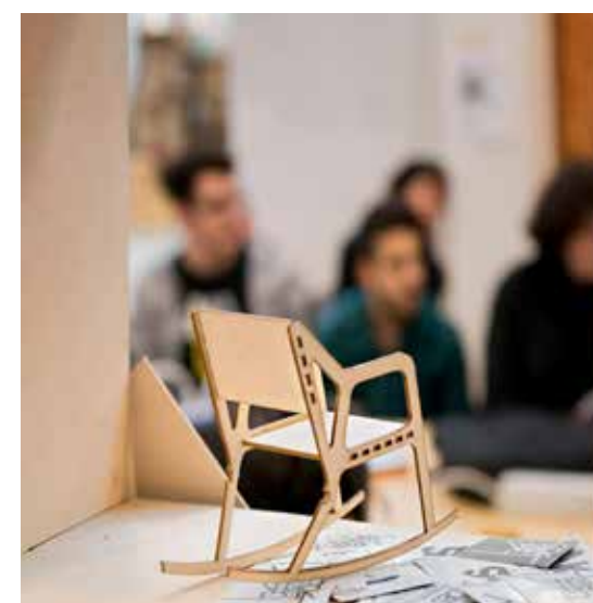
A sinistra, la "Cadreghina", realizzata con taglio al laser nel laboratorio Vectorialism, fabbrica digitale dal 2012 a Sesto San Giovanni. In basso, la stampante 3D del Fab Lab Milano. Foto Vectorialism e Silvia Ricciardi
